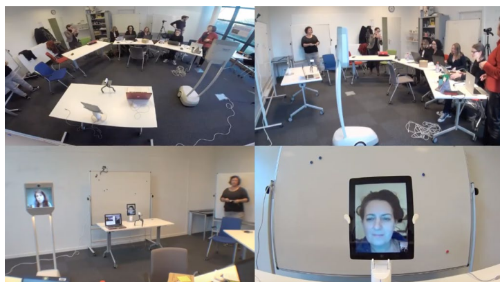
Figure 2 : robots de téléprésence, Beam et Kubi
