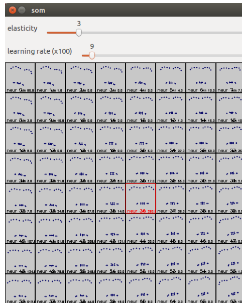
FIGURE 3 – Carte DSom apprenant les traits du visage. Chaque carré gris représente une classe différente, les points noirs montrent la forme de traits apprise
